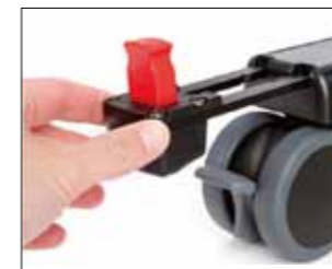
走行安定装置 キャスターの向きを固定し、走行を安定させます。
