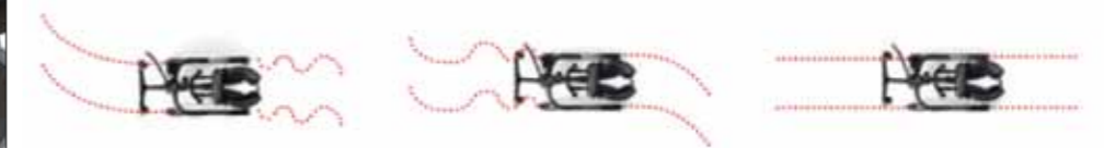
走行安定装置 キャスターの向きを固定し、走行を安定させます。
