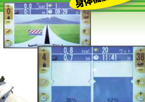
▲下肢訓練時 左右の脚力を棒グラフ表示。上の例では「左に38%の力、右は62%の力を使っている」ことを表しています。
