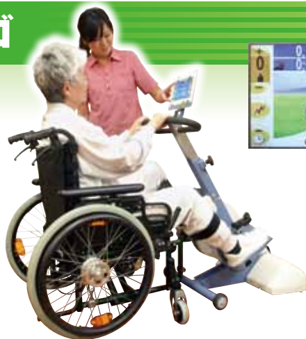
▲下肢訓練時 左右の脚力を棒グラフ表示。上の例では「左に38%の力、右は62%の力を使っている」ことを表しています。
