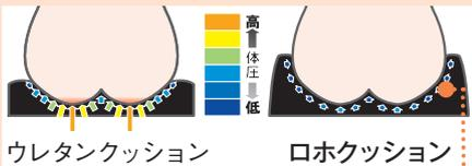
**空気室（エアセル）** 圧力でエアセルがつぶれても、隣りしてその隣のエアセルへと空気が伝播して体圧を分散します。
