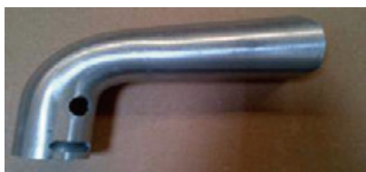
ハイドロフォーミング技法により形成されたベースフレームとキャスターフレーム
