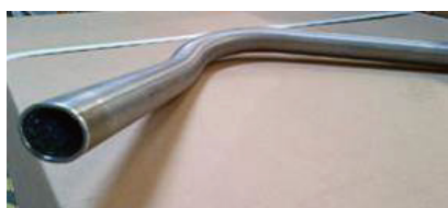
ハイドロフォーミング技法により形成されたベースフレームとキャスターフレーム
